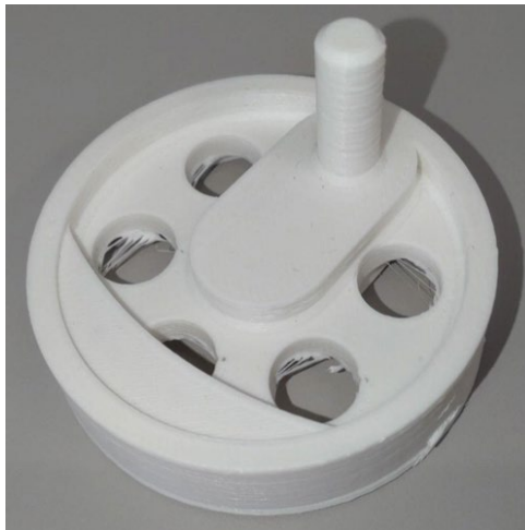
図 10. 3D プリンターで製作したハンドル（円盤プレート）
