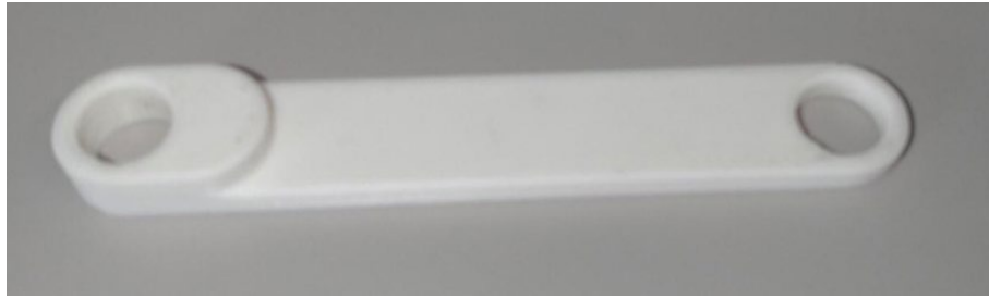
図 12. 3D プリンターで製作した脚部のリンク（図 11 左上）
