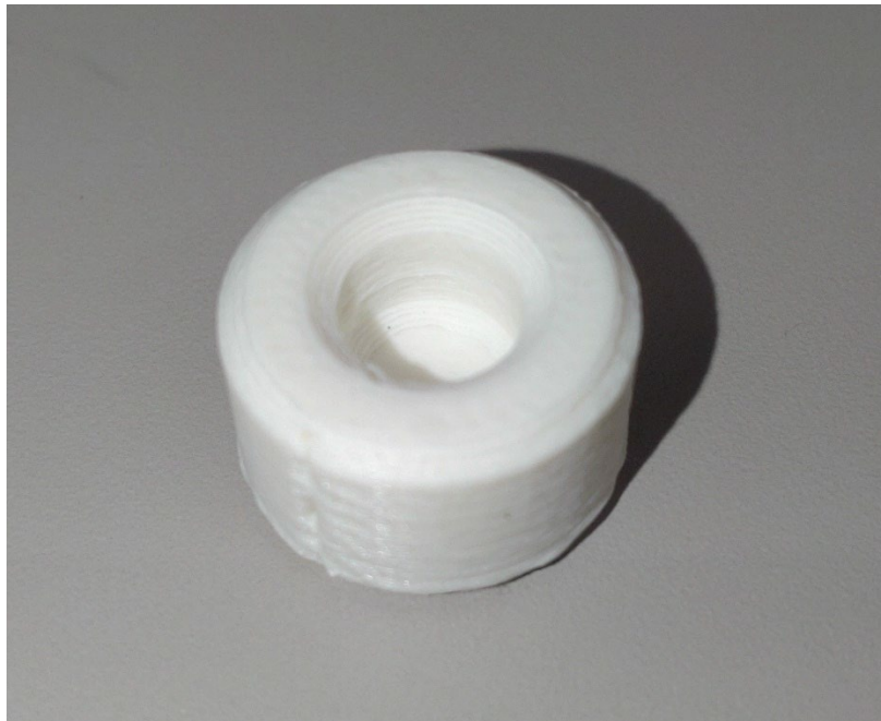
図 19. 3D プリンターで製作したジョイントキャップ
