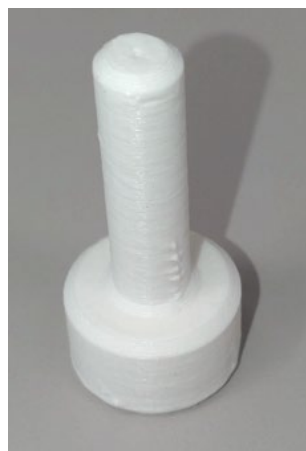
図 17. 3D プリンターで製作したジョイントピン
