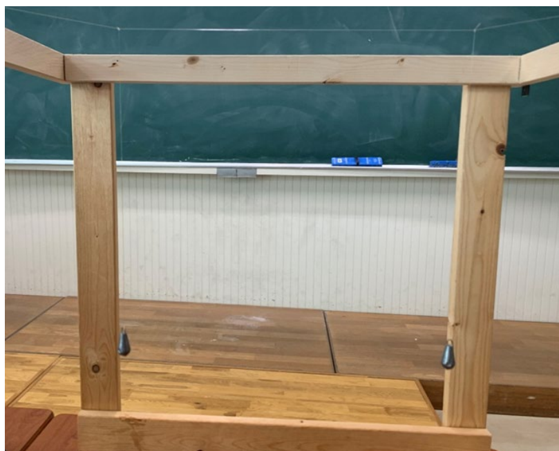
図 7 振り子を二個吊るした装置
