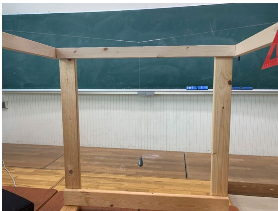
図 5 糸に振り子を吊るした装置
