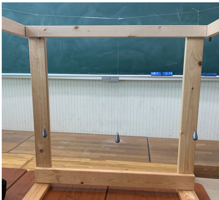
図 10 振り子を三個吊るした装置
