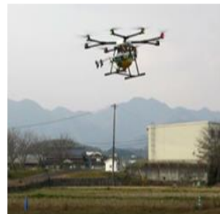
図1-4 ドローン飛行場での水噴霧試験状況
