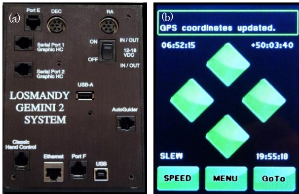
図 2 ジェミニ 2 システム (a) メインコントロールパネル (b) ハンドコントローラのタッチパネル
