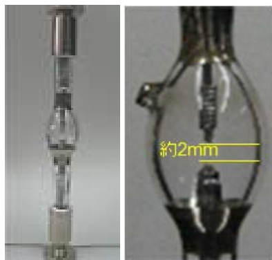
図1 超高圧水銀ランプの外管
