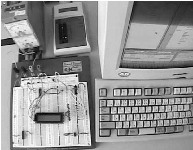
図 7 PIC による LED および LCD 制御
